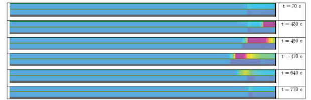
Рис. 14. Распределения плотностей \rho_m и \rho_k в левой и правой полосах транспортного потока в зависимости от координаты расчетной области x в различные моменты времени для случая отсутствия подвижной пробки. Движение транспортного потока происходит слева направо
